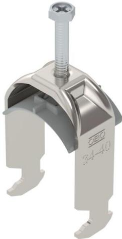
Bügelschelle mit Hammerkopf-Fuß, Kunststoffdruckwanne aus Polypropylen. Zur vertikalen und horizontalen Montage von 1 Einzelkabel an C-Proflschiene. Für Schlitzweite 16 - 17 mm. Mit 1-gängiger Schraube an Druckwanne, universeller Sechskant-Schraubenkopf SW10, mit Schlitz und Kreuzschlitz. Geeignet für Montage im Innen-und Außenbereich. Der Einsatz einer Gegenwanne wird empfohlen.
