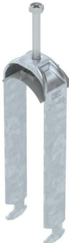
Bügelschelle mit Hammerkopf-Fuß, Kunststoffdruckwanne aus Polypropylen. Zur vertikalen und horizontalen Montage von 3 Einzelkabeln an C-Profilschiene. Für Schlitzweite 16 - 17 mm. Mit 1-gängiger Schraube an Druckwanne, universeller Sechskant-Schraubenkopf SW10, mit Schlitz und Kreuzschlitz. Geeignet für Montage im Innen- und Außenbereich. Mehrere Kabel sollten durch Doppelwanne getrennt werden. Der Einsatz einer Gegenwanne wird empfohlen.
