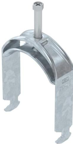
Bügelschelle mit Hammerkopf-Fuß, Metalldruckwanne mit gerundeten Kanten für Kabelschutz. Zur vertikalen und horizontalen Montage von 1 Einzelkabel an C-Profilsschiene. Für Schlitzweite 16 - 17 mm. Mit 1-gängiger Schraube an Druckwanne, universeller Sechskant-Schraubenzapfen SW10, mit Schlitz und Kreuzschlitz. Geeignet für Montage im Innen- und Außenbereich. Gegenwanne muss separat bestellt werden.
