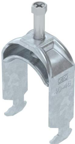
Bügelschelle mit Hammerkopf-Fuß, Metalldruckwanne mit gerundeten Kanten für Kabelschutz. Zur vertikalen und horizontalen Montage von 1 Einzelkabel an C-Profilsschiene. Für Schlitzweite 16 - 17 mm. Mit 1-gängiger Schraube an Druckwanne, universeller Sechskant-Schraubenkopf SW10, mit Schlitz und Kreuzschlitz. Geeignet für Montage im Innen- und Außenbereich. Gegenwanne muss separat bestellt werden.
