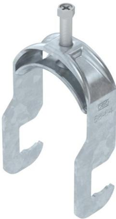
Bügelschelle mit RS-Fuß, Metalldruckwanne mit gerundeten Kanten für Kabelschutz. Zur vertikalen und horizontalen Montage von 1 Einzelkabel an Rundprofilen oder Rohren. Mit 1-gängiger Schraube an Druckwanne, universeller Sechs-kant-Schraubenzkopf SW10, mit Schlitz und Kreuzschlitz. Passend zu allen Rundprofileisen bzw. Rohren mit Durchmesser bis 22 mm. Geeignet für Montage im Innen- und Außenbereich. Der Einsatz einer Gegenwanne wird empfohlen.
