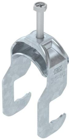
Bügelschelle mit RS-Fuß, Metalldruckwanne mit gerundeten Kanten für Kabelschutz. Zur vertikalen und horizontalen Montage von 1 Einzelkabel an Rundprofilen oder Rohren. Mit 1-gängiger Schraube an Druckwanne, universeller Sechskant-Schraubenzkopf SW10, mit Schlitz und Kreuzschlitz. Passend zu allen Rundprofileisen bzw. Rohren mit Durchmesser bis 22 mm. Geeignet für Montage im Innen- und Außenbereich. Der Einsatz einer Gegenwanne wird empfohlen.
