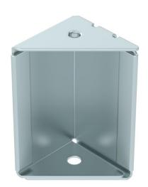
Zusatzstütze zur Aufständerung des begehbaren Kabelrinnensystems BKRS am Boden. Notwendig bei Aufständerungen mit Z-Stützen ZST ab Rinnenbreite 500 mm. Befestigung mit Flachkopfschraube FKS 6x12 mm (Art.-Nr. 6049246).
