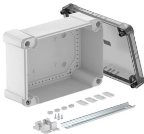
Kabelabzweigkasten mit Hutprofilschiene zum Verbinden von Kabeln und Leitungen im Innen- und Außenbereich. Rechteckige Form ohne Einführungen. Geeignet für die Wand-/ Deckenmontage mit der Möglichkeit zur Außenbefestigung, Innenbefestigung oder Montage über die Eckdome. Besonders schlagfest mit IK08. Transparenter Deckel mit Schnellverschluss, plombierbar. Hergestellt aus halogenfreien und UV-resistenten Materialien.
