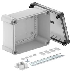
Kabelabzweigkasten mit Hutprofilschiene zum Verbinden von Kabeln und Leitungen im Innen- und Außenbereich. Rechteckige Form ohne Einführungen. Geeignet für die Wand-/ Deckenmontage mit der Möglichkeit zur Außenbefestigung, Innenbefestigung oder Montage über die Eckdome. Besonders schlagfest mit IK09. Transparenter Deckel mit Schnellverschluss, plombierbar. Hergestellt aus halogenfreien und UV-resistenten Materialien.
