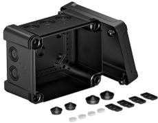
Kabelabzweigkasten zum Verbinden von Kabeln und Leitungen im Innen- und Außenbereich. Rechteckige Form mit Ausschlageinführungen. Geeignet für die Wand-/ Deckenmontage mit der Möglichkeit zur Außenbefestigung, Innenbefestigung oder Montage über die Eckdome. Besonders schlagfest mit IK09. Deckel mit Schnellverschluss, plombierbar. Hergestellt aus halogenfreien und UV-resistenten Materialien.
