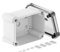
Kabelabzweigkasten zum Verbinden von Kabeln und Leitungen im Innen- und Außenbereich. Rechteckige Form ohne Einführungen. Geeignet für die Wand-/ Deckenmontage mit der Möglichkeit zur Außenbefestigung, Innenbefestigung oder Montage über die Eckdome. Besonders schlagfest mit IK09. Transparenter Deckel mit Schnellverschluss, plombierbar. Hergestellt aus halogenfreien und UV-resistenten Materialien.
