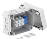
Kabelabzweigkasten mit Klemme zum Verbinden von Kabeln und Leitungen im Innen- und Außenbereich. Rechteckige Form mit Ausschlageinführungen. Geeignet für die Wand-/ Deckenmontage mit der Möglichkeit zur Außenbefestigung, Innenbefestigung oder Montage über die Eckdome. Besonders schlagfest mit IK09. Deckel mit Schnellverschluss, plombierbar. Hergestellt aus halogenfreien und UV-resistenten Materialien.
