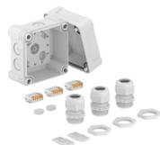
Kabelabzweigkasten mit Klemme zum Verbinden von Kabeln und Leitungen im Innen- und Außenbereich. Quadratische Form mit Ausschlageinführungen. Geeignet für die Wand-/ Deckenmontage mit der Möglichkeit zur Außenbefestigung, Innenbefestigung oder Montage über die Eckdome. Besonders schlagfest mit IK09. Deckel mit Schnellverschluss, plombierbar. Hergestellt aus halogenfreien und UV-resistenten Materialien.
