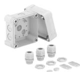
Kabelabzweigkasten zum Verbinden von Kabeln und Leitungen im Innen- und Außenbereich. Quadratische Form mit Ausschlageinführungen. Geeignet für die Wand-/ Deckenmontage mit der Möglichkeit zur Außenbefestigung, Innenbefestigung oder Montage über die Eckdome. Besonders schlagfest mit IK09. Deckel mit Schnellverschluss, plombierbar. Hergestellt aus halogenfreien und UV-resistenten Materialien.
