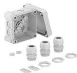
Kabelabzweigkasten mit Klemmleiste zum Verbinden von Kabeln und Leitungen im Innen- und Außenbereich. Quadratische Form mit Ausschlageinführungen. Geeignet für die Wand-/ Deckenmontage mit der Möglichkeit zur Außenbefestigung, Innenbefestigung oder Montage über die Eckdome. Besonders schlagfest mit IK09. Deckel mit Schnellverschluss, plombierbar. Hergestellt aus halogenfreien und UV-resistenten Materialien.
