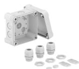
Kabelabzweigkasten zum Verbinden von Kabeln und Leitungen im Innen- und Außenbereich. Quadratische Form mit Ausschlageinführungen. Geeignet für die Wand-/ Deckenmontage mit der Möglichkeit zur Außenbefestigung, Innenbefestigung oder Montage über die Eckdome. Besonders schlagfest mit IK09. Deckel mit Schnellverschluss, plombierbar. Hergestellt aus halogenfreien und UV-resistenten Materialien.
