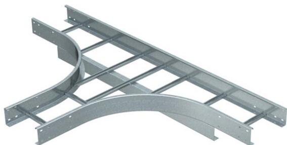
T-Stück, horizontal, für alle Weitspannkabelleitern mit der Seitenhöhe 110 mm. Zur weiteren Stabilisierung sollten im Bereich der Formteile Unterstützungen vorgesehen werden.
