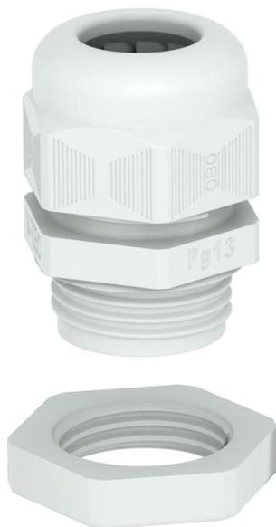
Kabelverschraubung mit PG-Anschlussgewinde in Hutmutterbauart, für Kabelabzweigkästen, Gehäuse, Verteilerkästen im privaten und industriellen Bereich. Mit Zugentlastung und integrierter Dichtlippe, geprüft nach DIN EN 62444. Schutzklasse IP68. Einsetzbar von -20°C bis +65°C. Inklusive Gegenmutter.
