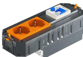
Anschlussfertiger Universalträger Connect UTC4 mit WAGO Steckverbindersystem WINSTA® MIDI. Passend zu den Verbindungsleitungen VL-WIN und für den Einsatz in den Geräteeinbaueinheiten der Nenngröße R7, 9 und R9. Der anschlussfertige Universalträger UTC4 FI verfügt über 2, mit FI/LS abgesicherte, Schutzkontakt-Steckdosen. Interne Verdrahtung mit 2,5 mm<sup>2</sup>. Bitte beachten Sie die Anschlussbedingungen (und auch die Selektivität)!
