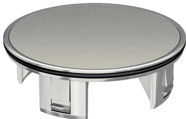
Höhenvariabler Leitungsauslass zum Einbau in Rahmenkassetten RKF sowie in nivellierbaren runden und quadratischen Kassetten RKFR und RKFN. Im genutzten Zustand fußbodenüberragend, im nicht genutzten Zustand fußbodenbündig. Einsatz in nass gepflegten Fußböden. Tubusabdeckung aus V2A.
