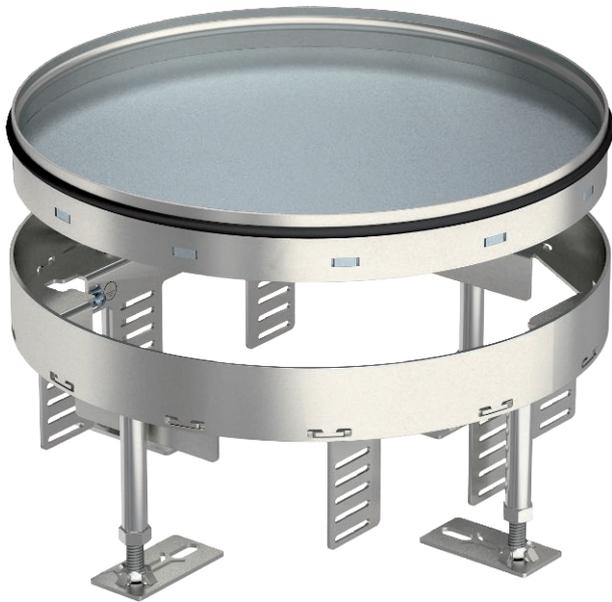
Runde Kassette Schwerlast "blind" in Nenngröße R7 für die Herstellung einer Revisionsöffnung in Kanalsystemen, Doppel- und Hohlböden, in trocken oder nass gepflegten Fußböden im Innenbereich. Belastungsklasse 2 bis 20 kN. Nur für glatte Bodenbeläge geeignet.
