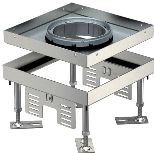
Quadratische Kassette Schwerlast für Tubus in Nenngröße 4 für den Einbau von Installationsgeräten in Kanalsystemen, Doppel- und Hohlböden, in trocken oder nass gepflegten Fußböden im Innenbereich. Belastungsklasse 1 bis 10 kN.
