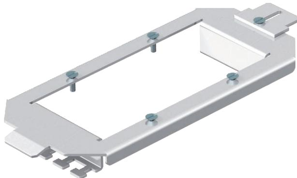
Montageträger zur Aufnahme von 2 bzw. 3 Datenmodulen Typ ACO (nur mit Insta Kit UF60 von AMP Tyco). Einbau anstelle eines Gerätebeckers GB2 oder GB3.
