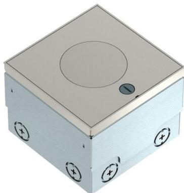
Quadratische Einbaueinheit für den Einsatz in trocken und nass gepflegten Holzböden und Estrichböden. Einbaugehäuse mit vorgeprägten Einführungsöffnungen für Rohre (M25). Oberteil durch 4 Nivellierstützen auf Oberkante Bodenbelag einstellbar. Die Mindesteinbautiefe beträgt 110 mm, der Nivellierbereich + 25 mm.
