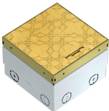
Quadratische Bodensteckdose für den Einsatz in trocken gepflegten Holzböden und Estrichböden. Einbaugehäuse mit vorgeprägten Einführungsöffnungen für Rohre (M20/M25). Oberteil durch 4 Nivellierstützen auf Oberkante Bodenbelag einstellbar. Die Mindesteinbautiefe beträgt 100 mm, der Nivellierbereich + 35 mm.
