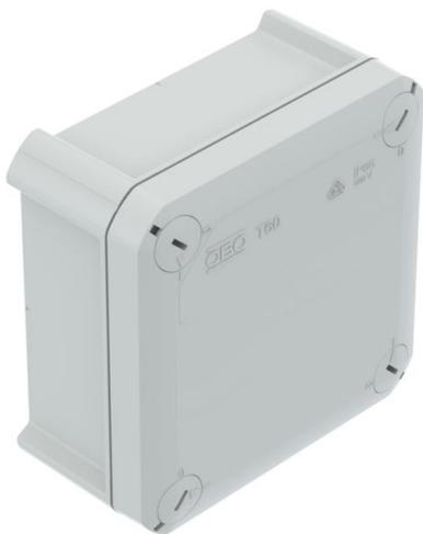
Kabelabzweigkasten zum Verbinden von Kabeln und Leitungen im Innenbereich und geschützten Außenbereichen. Quadratische Form ohne Einführungen. Geeignet für die Wand-/ Deckenmontage und die Montage auf Montageblechen. Mit der Möglichkeit zur Innenbefestigung und Montage über die Eckdome. Deckel mit Schnellverschluss, plombierbar. Hergestellt aus halogenfreien und UV-resistenten Materialien.
