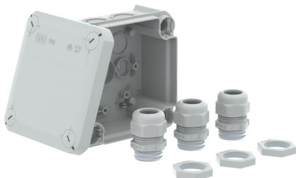
Kabelabzweigkasten zum Verbinden von Kabeln und Leitungen im Innenbereich und geschützten Außenbereichen. Quadratische Form mit Ausschlageinführungen an den Seiten und Ausschlageinführungen im Boden. Geeignet für die Wand-/ Deckenmontage und die Montage auf Montageblechen. Mit der Möglichkeit zur Innenbefestigung und Montage über die Eckdome. Deckel mit Schnellverschluss, plombierbar. Hergestellt aus halogenfreien und UB-resistenten Materialien.
