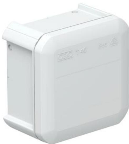
Kabelabzweigkasten zum Verbinden von Kabeln und Leitungen im Innenbereich und geschützten Außenbereichen. Quadratische Form ohne Einführungen. Geeignet für die Wand-/ Deckenmontage und die Montage auf Montageblechen. Mit der Möglichkeit zur Innenbefestigung und Montage über die Eckdome. Mit festsitzendem Klemmdeckel. Hergestellt aus halogenfreien und UV-resistenten Materialien.
