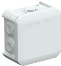
Kabelabzweigkasten zum Verbinden von Kabeln und Leitungen im Innenbereich und geschützten Außenbereichen. Quadratische Form mit Einsteckdichtungen an den Seiten und Ausschlageinführungen im Boden. Geeignet für die Wand-/ Deckenmontage und die Montage auf Montageblechen. Mit der Möglichkeit zur Innenbefestigung. Mit festsitzendem Klemmdeckel. Hergestellt aus halogenfreien und UV-resistenten Materialien.
