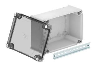
Kabelabzweigkasten geschlossen zum Verbinden von Kabeln und Leitungen im Innenbereich und geschützten Außenbereichen. Rechteckige Form ohne Einführungen. Geeignet für die Wand-/ Deckenmontage, die Montage auf Montageblechen und Gewinde im Boden. Mit der Möglichkeit zur Innenbefestigung und Montage über die Eckdome. Hoher, transparenter Deckel mit Schnellverschluss, plombierbar. Hergestellt aus halogenfreien Materialien. Inklusive Hutprofilschiene.
