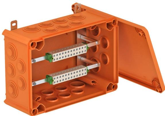
Halogenfreier Kabelabzweigkasten als Datenkleinverteiler mit vormontierten, weichen Einsteckdichtungen, zugelassen für den elektrischen Funktionserhalt gemäß DIN 4102 Teil 12. Funktionserhaltklassen E30 bis E90
