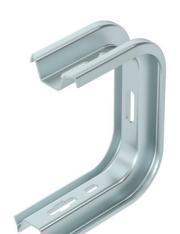
TP-Wand- und Deckenbügel für die universelle Bauwerksbefestigung. Wichtig! Wird der Bügel direkt an der Wand oder Decke befestigt, ist aus Stabilitätsgründen immer das Distanzstück Typ DS 4 einzusetzen.
