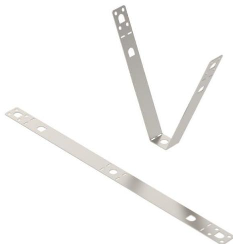
Trapezbefestigung zum Abhängen von Kabeltragsystemen von Standardtrapezdecken. Trapezprofilbreite bis 165 mm. Montage mit Riegel Typ TPB R oder Sechskantschraube Typ SKS 10x110. Befestigungsmaterial muss separat bestellt werden.
