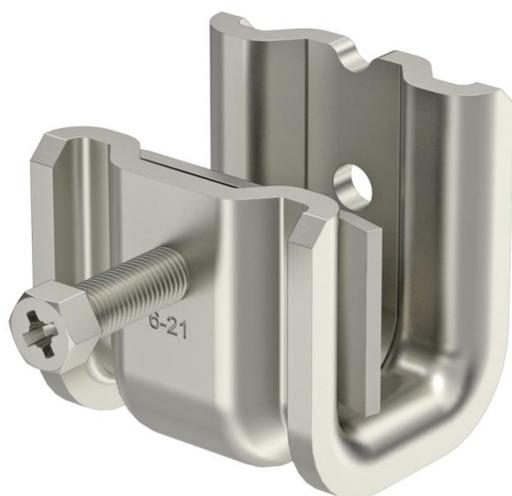
Diese Art Trägerklammer wird auf den Träger aufgeschoben und mittels einer Druckwanne und Schraube (M8) am Träger oder Flacheisen fixiert. Die Sechskantschraube hat eine Schlüsselweite von 10 mm. Im Schellenkörper sind außerdem zwei weitere M8 Gewinde eingebracht, um zum Beispiel Gewindestangen zu befestigen.
