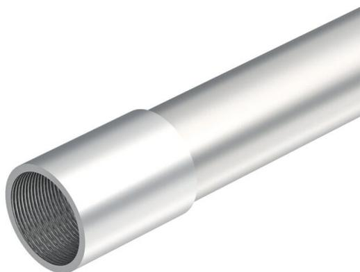
Elektroinstallationsrohr nach EN 61386-1, mit Gewindeenden nach DIN EN 60423, für den mechanischen Schutz von Kabeln und Leitungen. Mit gratfreier Innenwand. Pro Rohr ist bereits eine Verbindungsmuffe aufgeschraubt.
