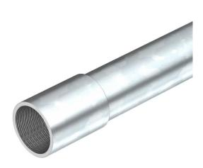
Elektroinstallationsrohr nach EN 61386-1, mit Gewindeenden nach DIN EN 60423, für den mechanischen Schutz von Kabeln und Leitungen. Mit gratfreier Innenwand. Korrosionsschutzklasse 2 (mittel). Pro Rohr ist bereits eine Verbindungsmuffe aufgeschraubt.
