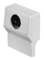
Geräteträger leer für die Sockelleistenkanal-Systeme SL, SL-L und SL-T zur Installation von Einbaugeräten in Tragbügelbauweise (nach DIN 49075) in den Kanalbreiten 50 und 70 mm.
