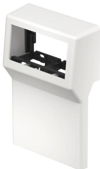
Geräteträger leer für die Sockelleistenkanal-Systeme SL, SL-L und SL-T zur Installation von Einbaugeräten in Modul 45-Bauweise für die Kanalbreite 110 mm. Beim Einsatz von Datenmodulen kann aufgrund der Bauform, die Einhaltung des vorgeschriebenen Biegeradius der Datenleitung ggf. nicht gewährleistet werden.
