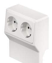
Geräteträger mit vorkonfektionierter 2-fach Schutzkontaktsteckdose mit erhöhtem Berührungsschutz für den Sockelleistenkanal in den Kanalbreiten 50 und 70 mm.
