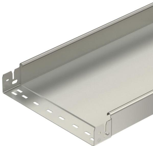
Ungelochte Kabelrinne mit integriertem Schnellbefestigungssystem. Die Nutzlänge der Kabelrinne beträgt 3.000 mm. Der durchgängige Potenzialausgleich ist ohne Zusatzbauteile gewährleistet.
