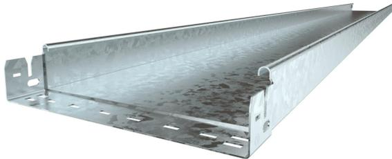
Ungelochte Kabelrinne mit integriertem Schnellbefestigungssystem. Die Nutzlänge der Kabelrinne beträgt 3.000 mm. Der durchgängige Potentialausgleich ist ohne Zusatzbauteile gewährleistet.
