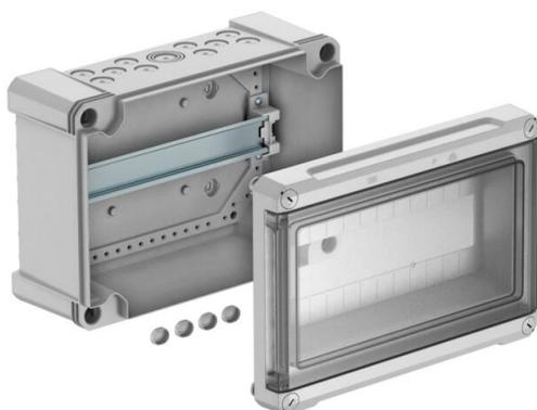
Kleinverteiler zur Aufputz-Montage, für die Strom-Unterverteilung im Innen- und geschützten Außenbereich, gemäß IEC 439-3. Mit vormontierter 35-mm-Hutprofilschiene. Schutzart IP66 und Schutzgrad IK07. Transparenter Deckel zum Schrauben, mit Ausschnitt.
