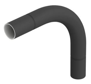
$90^\circ\textsc{-Bogen}$  mit angeformten Muffen, für Elektroinstallationsrohre nach EN 61386-1. Mit gratfreier Innenwand.
