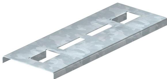
Sprossenauflegebleche zur Vergrößerung der Auflagefläche für die Kabel in den Formteilen für die Verlegearten mit Kabelleitern zum Funktionserhalt nach DIN 4102 Teil 12. Damit die Funktionserhaltskabel im Brandfall eine möglichst große Auflagefläche in den Kabelleiterformteilen haben, sind zusätzlich die Sprossenauflegebleche zu verwenden. Die Sprossenauflegebleche werden nur lose auf die Sprossen der Kabelleiterformteile gelegt. Die nach unten ausgebildeten Nasen verhindern ein Wegrutschen.
