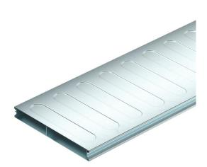
Unterflurkanal (2-teilig) zur Verlegung von Kabeln und Leitungen in estrichüberdeckten Unterflur-Systemen nach EN 50085-2-2. Abnehmbarer und durchgängig aufrastbarer Kanaldeckel. Mit Trennsteg im Kanalunterteil.
