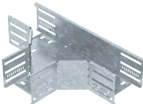
T-Stück zum Erstellen einer horizontalen Abzweigung, Formteil für rast- und schraubbare Kabelrinnen Seitenhöhe 85 mm. Schraubenlose Montage mit Doppelklemmen oder Schraubverbindung mit Flachrundschrauben FRS und Kombimuttern M6. Einsetzbar im Innen- und Außenbereich. Befestigungsmaterial muss separat bestellt werden.
