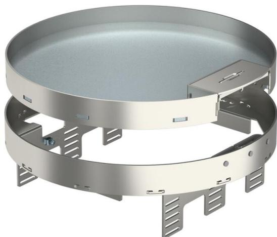
Nivellierbare und vom Fußboden entkoppelte Kassette der Nenngröße R9 mit Schnuraustritt, für den Einbau von Installationsgeräten in trocken gepflegten Fußböden im Innenbereich, zur Montage in Unterflurdosen UZD350-3 in Verbindung mit einem Montagedeckel DUG350-3R9 oder in UGD350-3R9. Die Montage erfolgt mittels Nivellierwinkeln (separat bestellen) im Aluminium-Rahmenprofil der Unterflurdosen.
