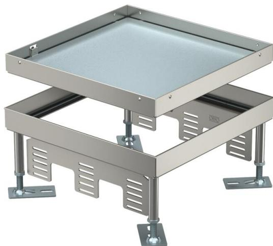
Nivellierbare quadratische Kassette Schwerlast "blind" in Nenngröße 9 für die Herstellung einer Revisionsöffnung. Einbau in Kanalsystemen, Doppel- und Hohlböden in trocken oder nass gepflegten Fußböden im Innenbereich. Belastungsklasse 1 bis 10 kN. Nur für glatte Bodenbeläge geeignet.
