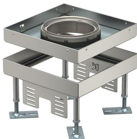
Nivellierbare quadratische Kassette für Tubus der Nenngröße 4 für den Einbau von Installationsgeräten in Kanalsystemen, Doppel- und Holzböden in trocken oder nass gepflegten Fußböden im Innenbereich. Schutzklasse: IP X5. Für den Einbau von 2 Universalträgern UT3 für 4 Einzel-Installationsgeräte mit Tragering/Tragebügel oder 6 Modul 45®-Geräte. Es können 2 Abdeckplatten APMT2 installiert werden.
