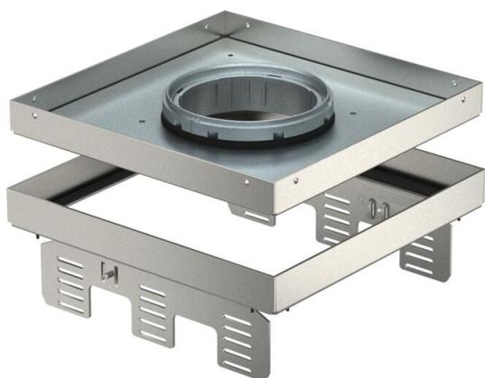
Nivellierbare und vom Fußboden entkoppelte Kassette der Nenngröße 9, für Tubus, für den Einbau von Installationsgeräten in trocken oder nass gepflegten Fußböden im Innenbereich, zur Montage in Unterflurdosen UZD250-3 oder UZD350-3, jeweils in Verbindung mit einem Montagedeckel DUG../9 oder in UGD250-3/9 oder UGD350-3/9. Die Montage erfolgt mittels Nivellierwinkeln (separat bestellen) im Aluminium-Rahmenprofil der Unterflurdosen.
